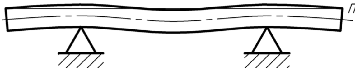
Рисунок 2.36 – Паралельність торців та найменша зміна довжини верхньої поверхні
