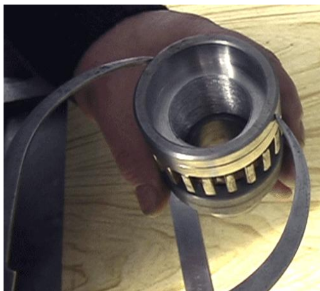
Рисунок 2.10-1 – Вимірювання зовнішніх розмірів кронциркулем
