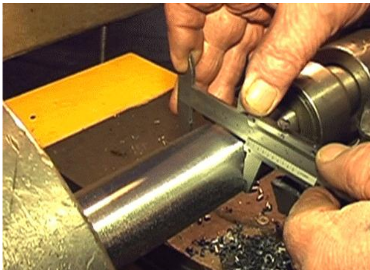
Рисунок 2.4 – Вимірювання деталі штангенциркулем після обробки
