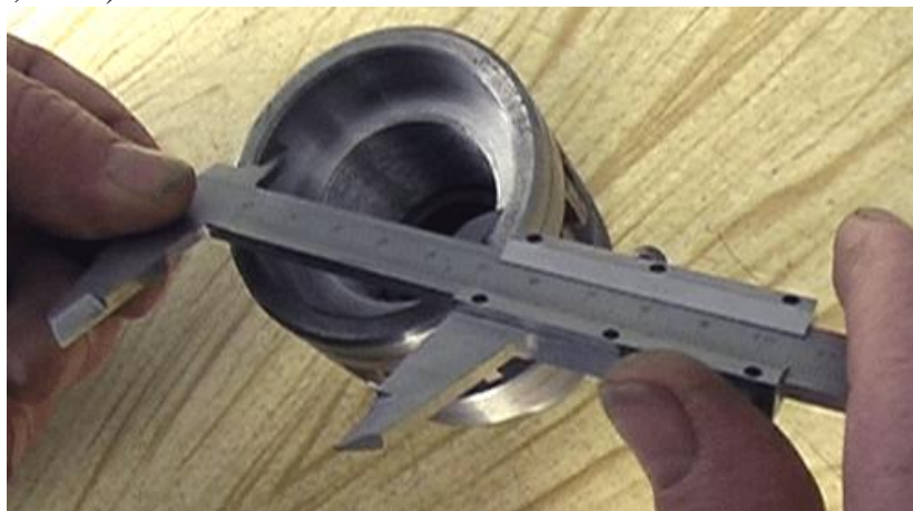
Рисунок 2.14 – Вимірювання отвору деталі
