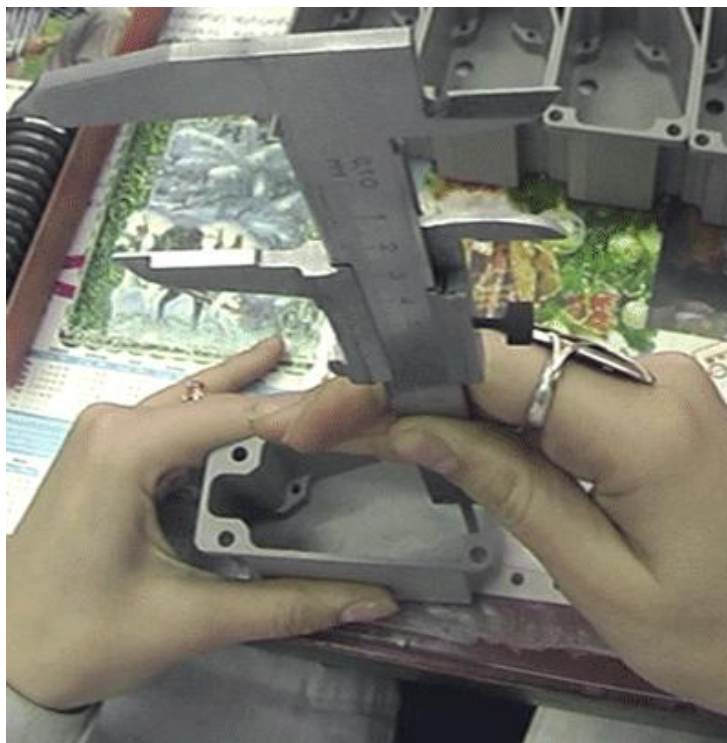
Рисунок 2.15 – Вимірювання розміру глибини деталі
