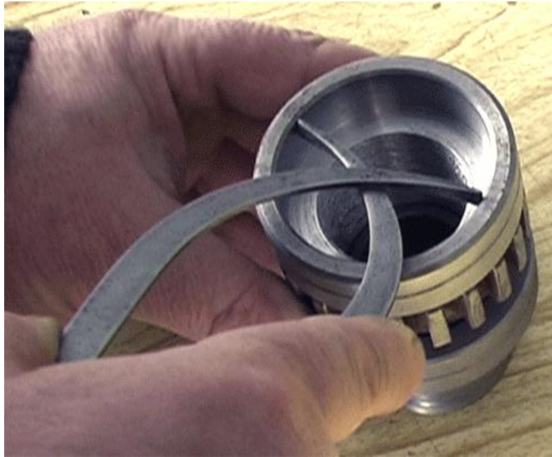
Рисунок 2.10-2 – Вимірювання внутрішніх розмірів кронциркулем
